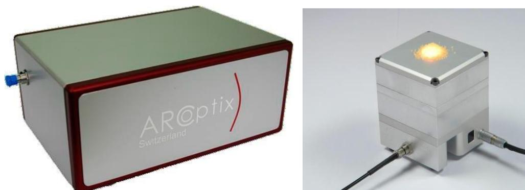
Рисунок 8.1 - ИК-спектрометр ARCOptix FT-NIR Rocket с интеграционной сферой ArcSphere-50-Hal
